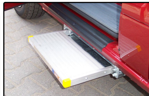
elektrische Trittstufe unterhalb an der Fahrersitzposition
