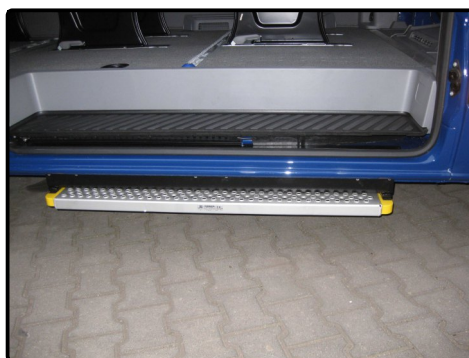
elektrische Trittstufe seitlich unterhalb am VW Crafter
