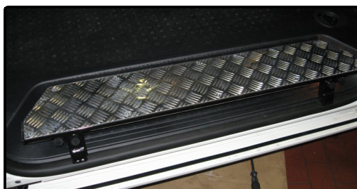
per Hand einklappbare Trittstufe im VW T5 Transporter
