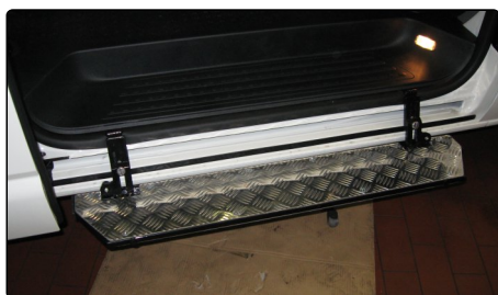
per Hand einklappbare Trittstufe im VW T5 Transporter
