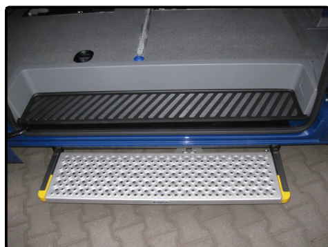
elektrische Trittstufe seitlich unterhalb am VW Crafter
