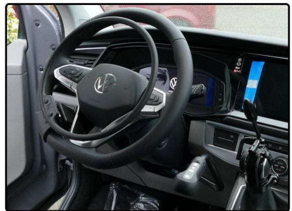
Gasring hinter dem Lenkrad
