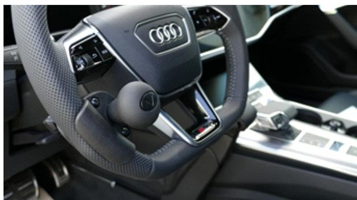
Für einarmige Fahrer oder Versehrte, die ihr Fahrzeug mit einem Handbediengerät fahren, ist zum vollen Lenkradeinschlag, z.B. beim Wenden oder Ausweichen, ein Lenkraddrehknopf unbedingt erforderlich. Der Drehknopf wird am Lenkrad befestigt und ist für alle Lenkradarten geeignet.
