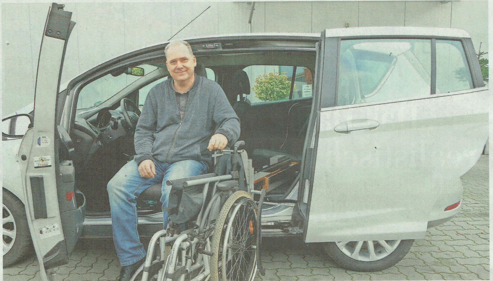
Holger Witzelsburger zeigt den schwenkbaren Fahrersitz zum Umstieg mit Rollstuhlvorrichtung.
