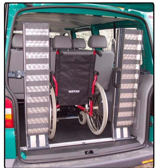
Auffahrschienen sind in unterschiedlichen Ausführungen und Längen erhältlich:
