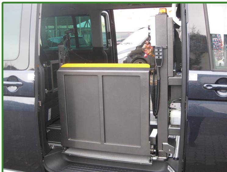
Der Rollstuhllift SF 350 II kann seitlich oder im Heck von Kleinbussen und Großraumlimousinen, z.B. VW T6/Crafter, Mercedes Vito/Sprinter oder auch Ford Transit, ohne Veränderung am Serienfahrzeug, montiert werden. Der Rollstuhlfahrer kann mit diesem Lift ohne fremde Hilfe ein- und aussteigen.
